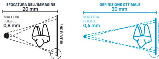
Aumento del parallelismo dei raggi X e collimatore incorporato consentono a RX DC VET di raggiungere una distanza fuoco-pelle di 30 cm. RX DC VET ti permette di avere immagini nitide, precise e grande livello di dettaglio.
